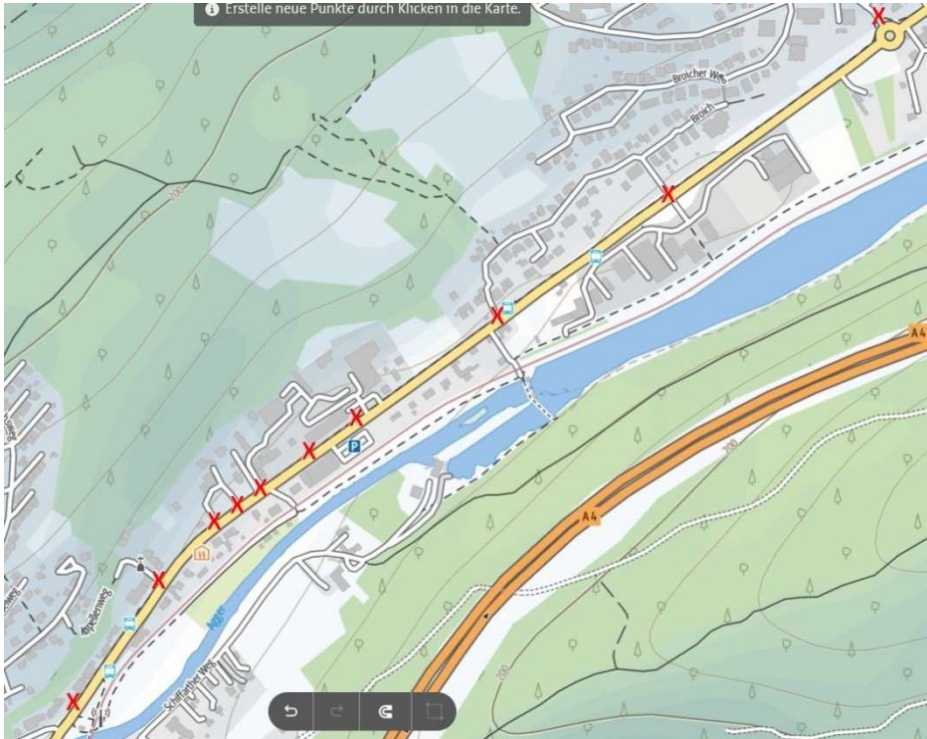
Karte 9: Gefahrenpunkte (x) am vorhandenen Radweg zwischen Loope und Grünscheid (ungesicherte Einmündungen und Ausfahrten)
